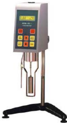
شکل ۵-۱۶: شمای کلی آزمایش ویسکوزیته دورانی [۶۴]
