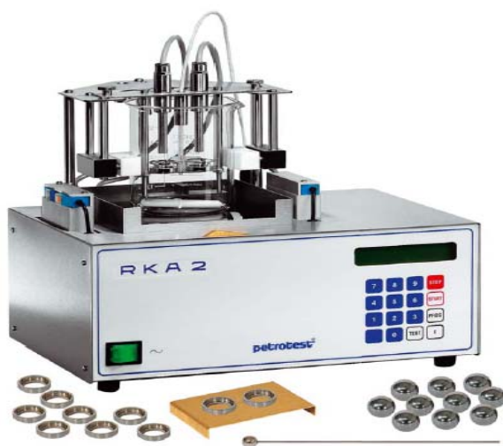
شکل ۵-۲ : دستگاه اندازه گیری نقطه نرمی مطابق با استاندارد ASTM D۳۶ [۶۴]
